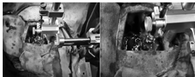
Obr. 4: Aplikácia vektoru pomocou 500 µl Hamilton striekačkou s 34G NanoFil ihlou (World Precision Instruments; NF34BV) za pomoci injekčného robota (Neurostar, Germany).
