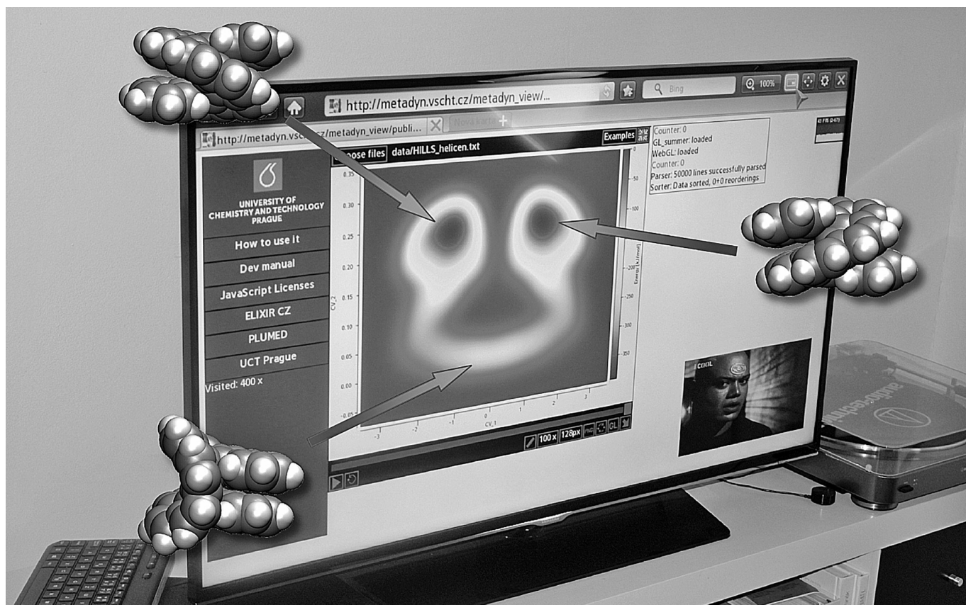
Obr. 1: Plocha volné energie racemizace [10]helicenu zobrazená na obrazovce Smart TV. Struktury a šipky ukazují levotočivou (vlevo) a pravotočivou (vpravo) formu helicenu a transitní stav racemizace (dole).
