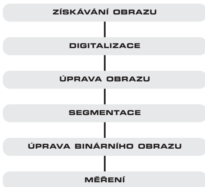
Obr. 1. Schéma metody analýzy obrazu
